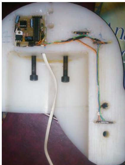
شکل ۴. محل نصب و نحوه قرارگیری سنسورها در سر
