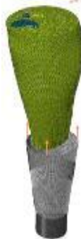
شکل ۹. شرایط مرزی و بارگذاری اعمال شده به مدل اجزاء محدود ساق پا-منسوج فشاری.
